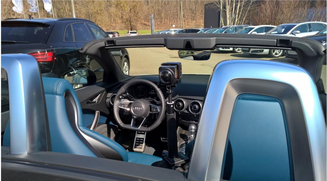
Abbildung 50: Platzierung der Kamera zwischen den beiden Sitzen (Bsp.3)
